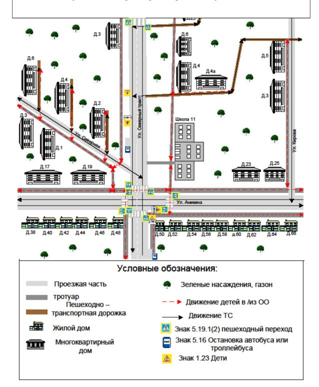
Схема организации дорожного движения в непосредственной близости от образовательного учреждения с размещением соответствующих технических средств,
